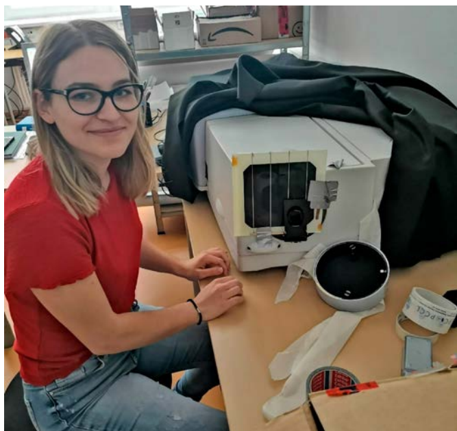
Monika ob delu z UV spektrometrom, s katerim je določevala refleksijo vzorca (panel sončnih celic).
